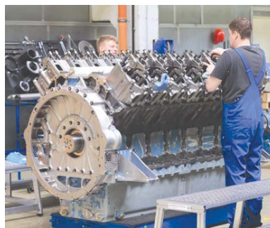
In einer Montagehalle der Firma „MTU Reman Technologies“ in Magdeburg wird am Zylinderkopf eines Motors gearbeitet.
